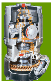
Сл. 6.2.4. Шематски приказ на процес на производство на пелети (систем: Туренки, Финска)
