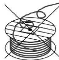
Неправилно одмотување на кабел
